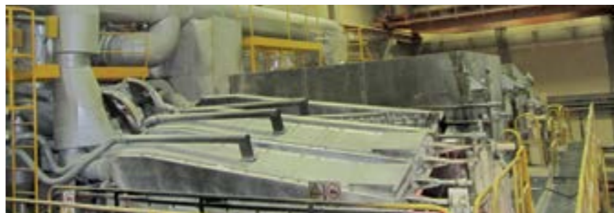
Izvedba uporabe izpušnih plinov iz infrardečega sušenja za ogrevanje sušilnih havb na Premaznem stroju. S predelavo so dosegli do 25% manjšo specifično porabo plina, na tono proizvedenega papirja. Use of exhaust gases from IR drying for the heating of drying hoods on the coating machine. Converting resulted in a 25% decrease of specific consumption of gas per tonne of paper produced.
