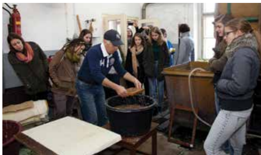
Mojstrska delavnica Vevče – papirniški mojster Jože Valant v sito zajema papirno kašo Vevče Craftsman Workshop – Jože Valant, a master of hand papermaking, is collecting pulp into a sieve
